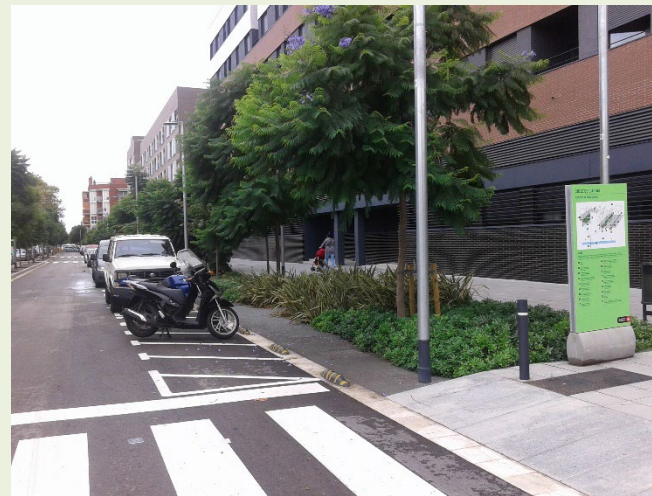
Cadena de SUDS: Pavimentos permeables, parterres inundables (jardines de lluvia y áreas de biorretención), alcorques con suelo estructural y carteles informativos sobre la gestión del agua de lluvia. Barrio del Bon Pastor en Barcelona. Fuente: Roberto Soto Fernández, «Instituto Municipal de Urbanismo, Ayuntamiento de Barcelona».
