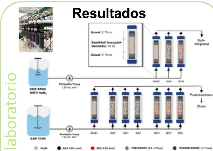
Figura 2. Esquema de columnas en laboratorio
