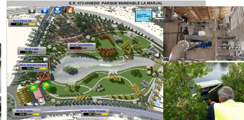
Figura 3. Versión digital (SCADA) del parque, sensórica de control, cuadros de mando y maniobra y elementos de comunicación en tiempo real.
